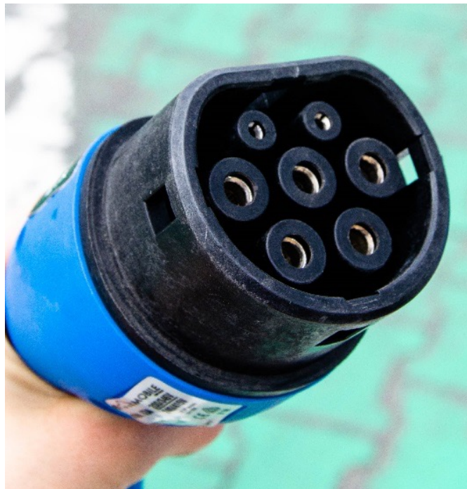
Zdjęcie 6. Wtyczka pojazdowa, standard Typ 2
