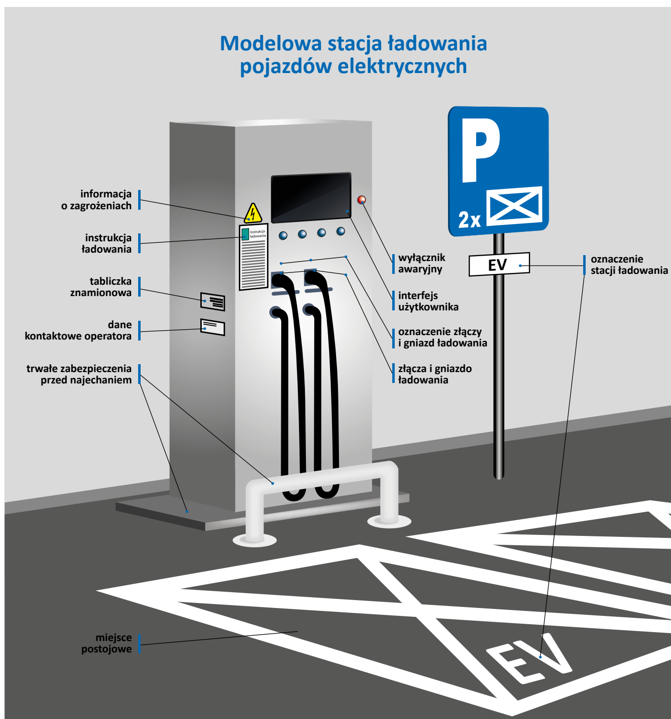
Rys. 2 Modelowa stacja ładowania pojazdów elektrycznych
